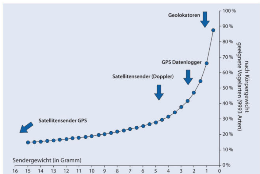
Einsatzmöglichkeiten verschiedener Technologien in Abhängigkeit von der Körpermasse einer Vogelart. Dabei wurde davon ausgegangen, dass ein Instrument nicht mehr als 5% der Körpermasse eines Tieres wiegen sollte. Abbildung verändert nach Bridge u. a., BioScience 61, 2011.
